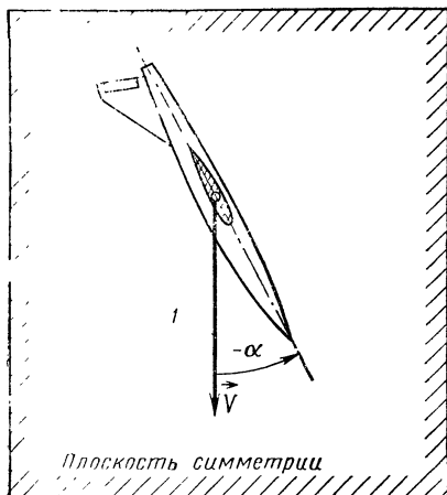
Рис. 36. Определение угла атаки \alpha в отвесном пикировании:
